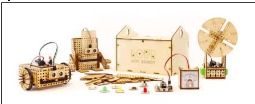
Rysunek 1. Zestaw EDUBOX i przykłady jego wykorzystania - robot pojazd, robot goryl, wiatrak 12
