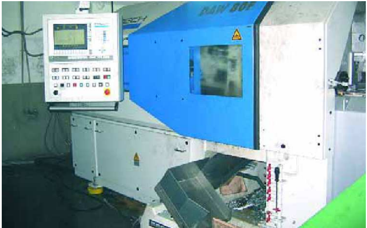
6. Maszyna ciśnieniowa do odlewania stopów magnezu. Ostona zabezpiecza przed skutkami rozszczelnienia formy.
